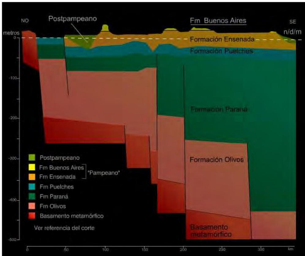
Figura 9: Esquema de corte estratigráfico suelo – subsuelo
